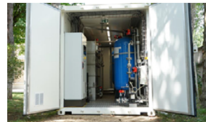
Conteneur UnYo : solution mobile pour traiter l'eau douce et fournir de l'eau potable
